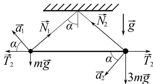
перпендикулярны нитям и одинаковы по модулю. Действительно, стержень – абсолютно твердое тело, проекции скоростей, а, следовательно, и ускорений шариков на горизонтальное направление равны. Масса стержня пренебрежимо мала, поэтому силы, с которыми стержень действует на шарики, направлены вдоль стержня и  $\vec{T}_1 = -\vec{T}_2$ . По второму закону Ньютона
