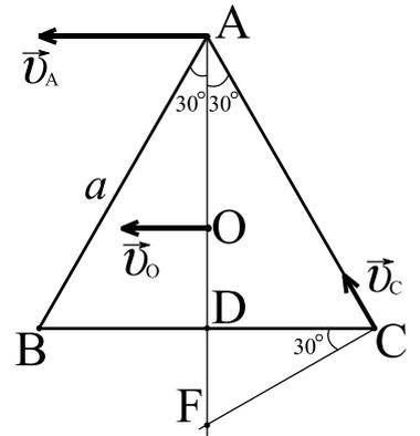
Система центра масс пластины – ИСО,  $\vec{R} = m\vec{a}$ ,  $R = m\omega^2 BO = m \left( \sqrt{3} \frac{v_C}{a} \right)^2 \frac{a}{\sqrt{3}}$
