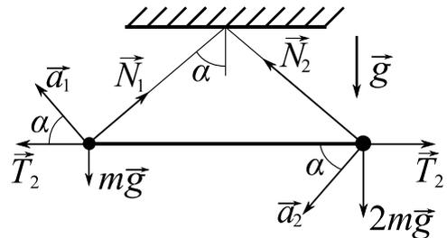
Перейдем к проекциям сил и ускорения на касательные направления:
