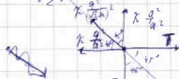
Т.к. шарж подвешен, равнодействующая всех сил равна нулю.
