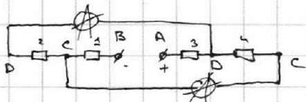
1) т.к.  $R_A \ll R$ , можно "заклеить" амперметр на узловой проводимости. Расставим (визуальное название) узлы цепи, так же пронумеруем все резисторы
