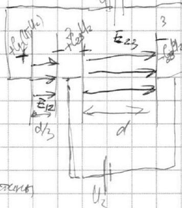
2) вектор  $E$  в обоих случаях сонаправлен со скоростью частицы  $\Rightarrow$  <sup>кондр</sup>  $\Rightarrow$  будет её разогнать
