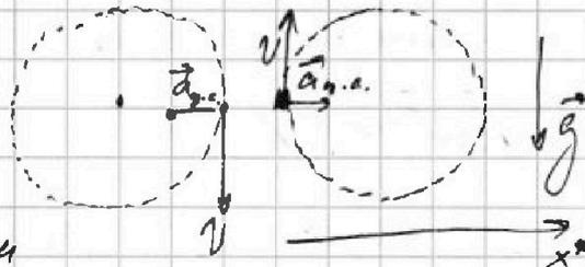
одинаковы т.к. их  $\vec{a}_{y.c.} \perp \vec{g}$  и  $|\vec{a}_{y.c.}| = |\vec{g}|$
