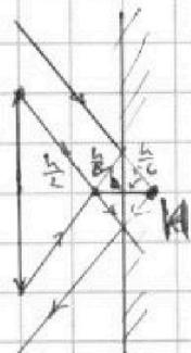
В силу симметрии изображение в зеркале имеет такое же расстояние от плоскости зеркала, что и изображение, создаваемое линзой.
