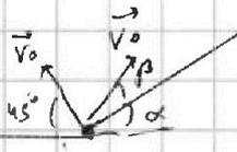
Наибольшее перемещение по горизонтальной плоскости определяется известной формулой:  $L = \frac{v_0^2}{g} \sin 2\alpha$
