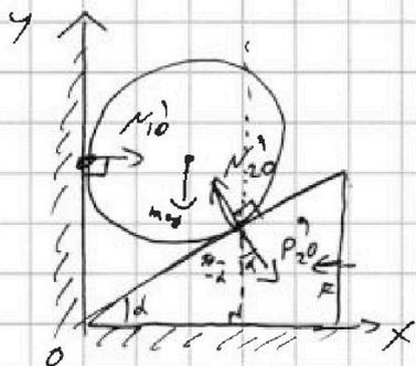
По III закону Ньютона, шар с такой же по модулю силой действует на клин. Назовем эту силу  $P_2^0$ . Если на клин действует сила  $F$ , то клин находится в равновесии, т.е. клин не ускоряется.
