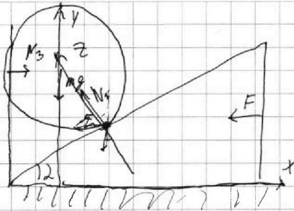
III. к. шарики покоятся в покое, то ускорение шарика = 0. Тогда закон Ньютона для тела 2 закон Ньютона по оси y:
