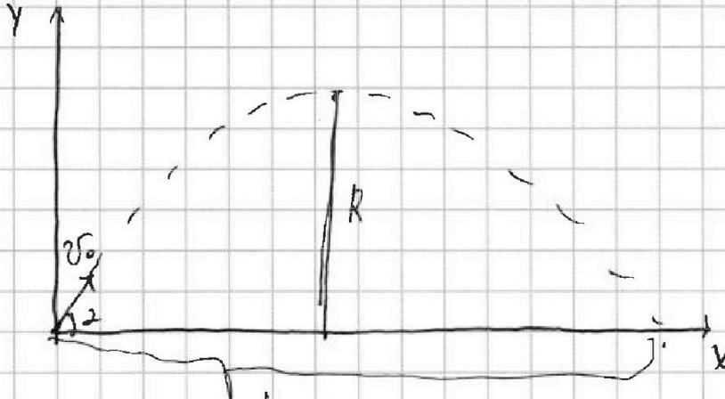
Пусть ось  $x$  направлена с началом отсчета  $v_0$  под углом  $\alpha$ . Тогда рассмотрим проекции на скорости на ось  $y$  и на ось  $x$ .
