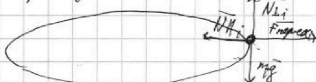
$N_{\parallel i}$ - вторая составляющая силы нормальной реакции опоры, действ. на пилота i-го самолёта
