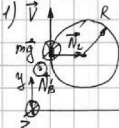
По III закону Ньютона:  $\vec{N} = -\vec{N}'$ ,  $N = N'$ , где  $N'$  - сила с которой шариком действует на поверхность. Разложим  $\vec{N}'$  на  $N_1$  и  $N_2$  - горизонт. составляю.,  $N_2$  - вертикал. сост.
