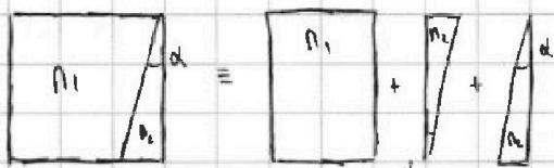
т.е. на плоскопараллельную пластинку и две начальные призмы
