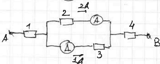
Т.к. показания у амперметров разные, сопротив. резисторов 2 и 3 тоже должны быть разными. Пусть  $R_2 = 20 \text{ Ом}$ ,  $R_3 = 40 \text{ Ом}$
