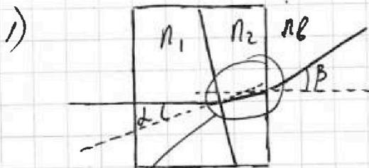
На рисунке фрагмент сист., через кот. проходит луч  $\perp$  левой грани;  $\beta$  - угол, на кот. луч отклонится
