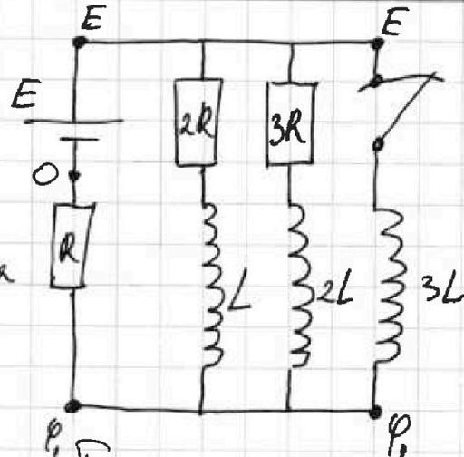
$$\begin{cases} E = 2R \cdot I_{10} + R \cdot I_0 \\ E = 3R \cdot I_3 + R \cdot I_0 \end{cases}, \text{ где } I_0 - \text{ток через источник,} \\ I_3 - \text{ток через резистор } 3R$$
