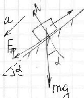
В первом опыте коробка будет двигаться с ускорением  $a = g \sin \alpha + \mu g \cos \alpha$ , направленным против скорости коробки.
