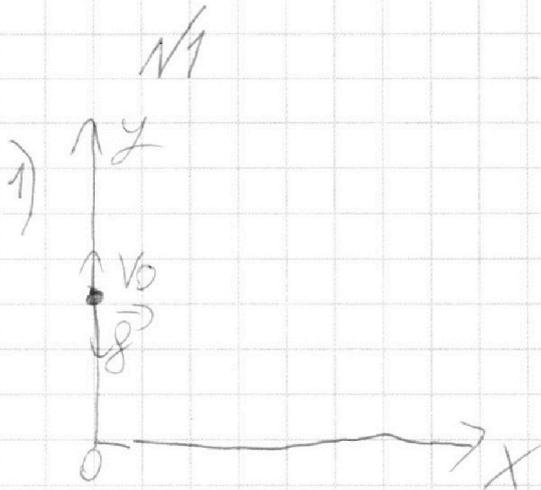
$$y(t) = V_0 t - \frac{gt^2}{2} \quad \text{высота}$$
