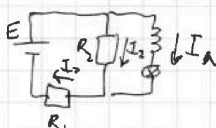
$$I = I_1 + I_2 \quad I_1 - \text{ток через лампу}$$
