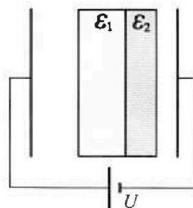
1) Найти напряженность электрического поля  $E$  в левом воздушном зазоре конденсатора.
