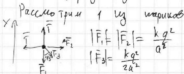
2-й з. Ньютона в проекции на X:  $T = \frac{kq^2}{a^2} + \frac{kq^2}{2a^2} \cos 45^\circ$
