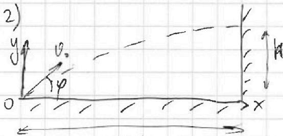
$\varphi$  - угол между землей и вектором нач. скорости. Он произвольный.
