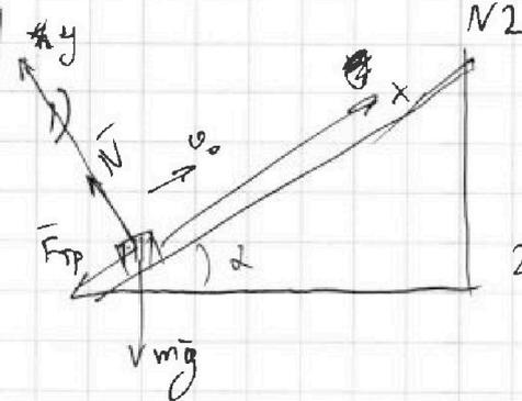
$N$  - модуль силы реакции опоры
