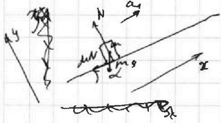
Пусть коробка движется с ускорением  $a_1$  параллельно вверх ската.  $m$  - масса коробки.
