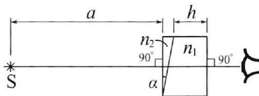
(см. рис.). Угол  $\alpha = 0,1$  рад можно считать малым, толщина  $h = 14$  см. Толщина призмы с показателем преломления  $n_2$  на прямой «источник – глаз» намного меньше  $h$ . Отражения в системе не учитывать.
