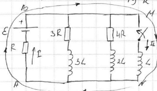
Сразу после замыкания ключа токи в цепи останутся такими же, как и непосредственно перед замыканием из-за катушек индуктивности в цепи.
