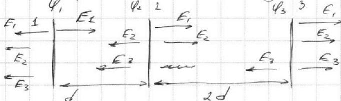
где  $E_1, E_2, E_3$  — направления полей соответствующих пластинок. сеток
