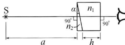
рис.). Угол  $\alpha = 0,05$  рад можно считать малым, толщина  $h = 9$  см. Толщина призмы с показателем преломления  $n_2$  на прямой «источник – глаз» намного меньше  $h$ . Отражения в системе не учитывать.
