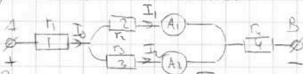
Заметим, что  $I_1 \neq I_2 \Rightarrow$  резисторы 2 и 3 имеют разные сопротивления,  $I_1 > I_2 \Rightarrow R_2 < R_3$  т.е. 2 и 3 соединены параллельно и  $U_2 = U_3 \Rightarrow R_2 = R_1, R_3 = R_2$
